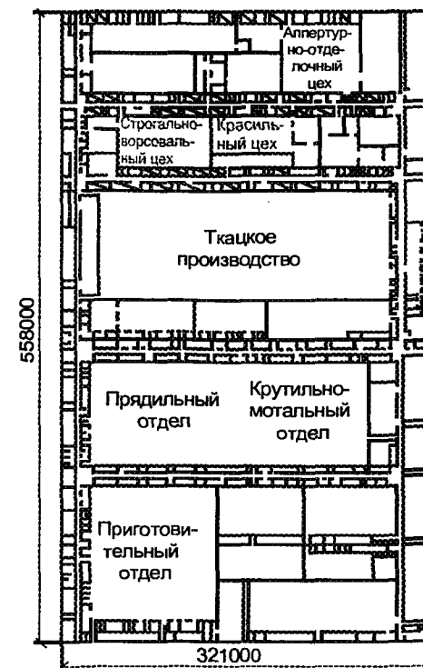
Рис. 9.7. План производственного корпуса хлопчатобумажного комбината
