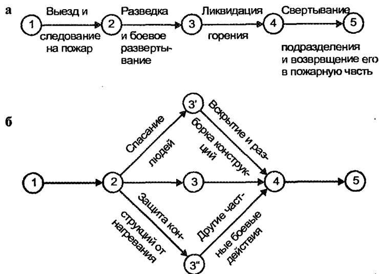
Рис. 3.3. Графики последовательности выполнения боевых действий одним подразделением: а - линейный график выполнения общих боевых действий (последовательный процесс); б - сетевой график выполнения общих и частных боевых действий (последовательно-параллельный процесс)
